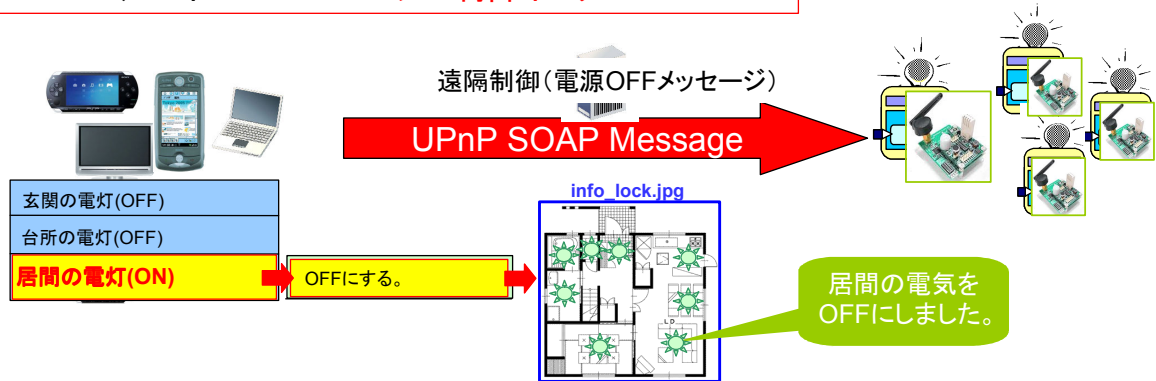
図 9. UPnP デバイスからの ZigBee デバイス操作
